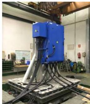
Photo : l'armoire prototype sur table vibrante
