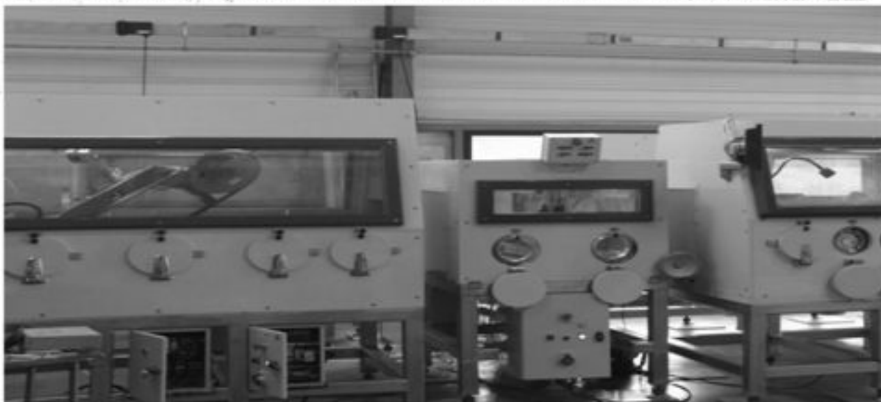
Les boîtes à-gants de CLM industrie permettent la manipulation de combustible ou d'éléments radioactifs. Photo SDR
